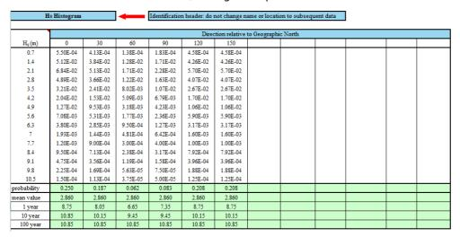
H<sub>s</sub>-T<sub>p</sub> Scatter Diagram input
